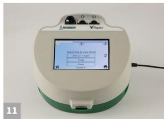
11 Los resultados se muestran en el lector Raptor. Las muestras superiores a 6 ppm necesitan ser diluidas y analizadas nuevamente.
