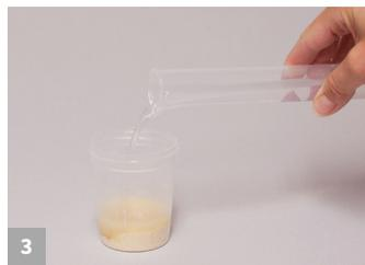
3 Añada 100 mL de agua destilada o desionizada a la muestra.
