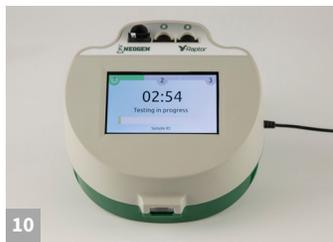
10 Añada 400  $\mu$ L de muestra del recipiente de dilución rojo a la parte posterior del cartucho Raptor. El lector se iniciará automáticamente.
