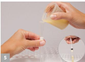
5 Deje reposar, filtre o centrifugue, recolecte un mínimo de 3 mL de filtrado.
