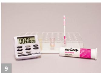
9 Coloque una nueva tira Reveal Q+ para Aflatoxinas en el recipiente de muestra. Configure un cronómetro para 6 minutos.
