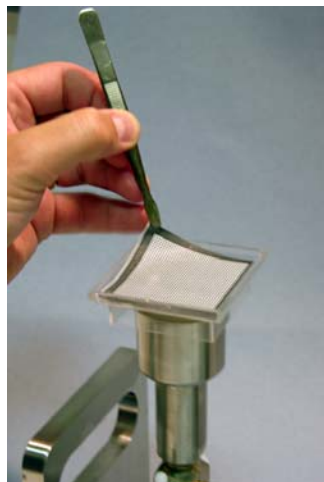
濾膜法操作流程簡易圖 2
